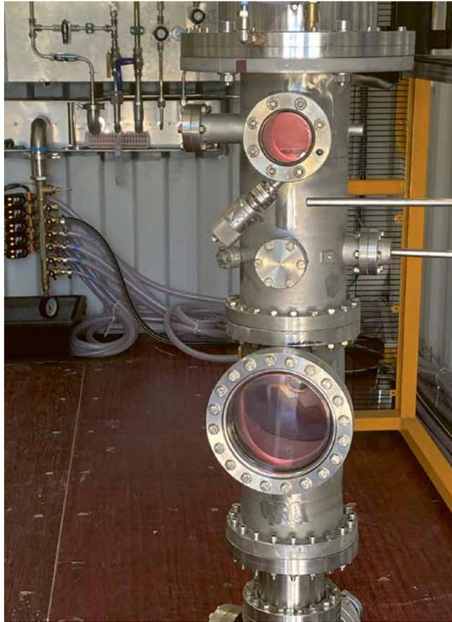
Die Methan-Pyrolyse spaltet Methan in Wasserstoff und festen Kohlenstoff. Quelle: Sakowin Green Energy
