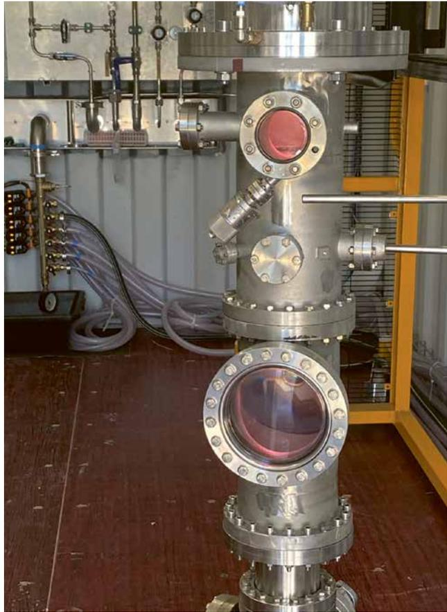
Par pyrolyse, le méthane est décomposé en hydrogène gazeux et en carbone solide. Source : sarkowin green energy
