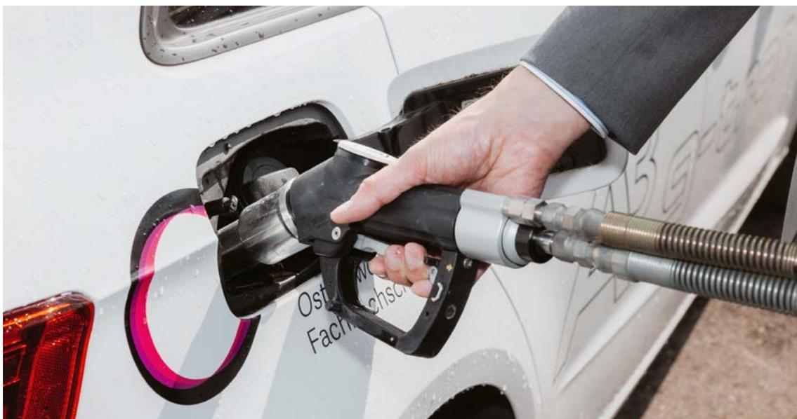
Betankung mit e-Methan aus der Pilotanlage
